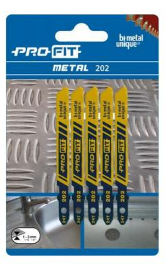
Lama 202 metallo 50x7,5x1 mm 24 Tpi, 5pz x blister Ideale per lavorazioni su metallicon uno spessore fino a 3 mm. Technologia BiMetal Unique unisce due strisce di HSS ad un rigido supporto di acciaio, utilizzando il sistema di saldatura per diffusione. Adatano a tutti i sehetti alternativi in commercio grazie al gambo universale.
