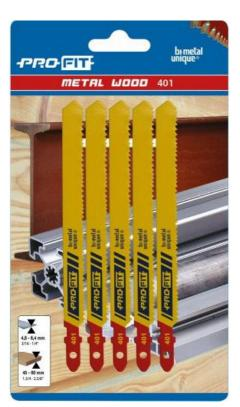
Lama 401 Multi legno / metallo 100x9,5x1 mm 10/14 Tpi, 5pz x blister Lama multipurpose per tagliare attraverso acciaio e legno. Viti e chiodi non sono piu un problema. Technologia BiMetal Unique unisce due strisce di HSS ad un rigido supporto di acciaio, utilizzando il sistema di saldatura per diffusione. Adatano a tutti i sehetti alternativi in commercio grazie al gambo universale.
