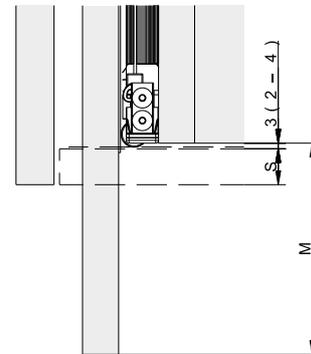
**Ferramenta per ante a scomparsa girevoli in legno fino a 35 kg. Allestimento del frontale uniforme e complanare con schema delle fughe omogeneo. Versione Pull con maniglia e sistema ammortizzatore integrato.**
