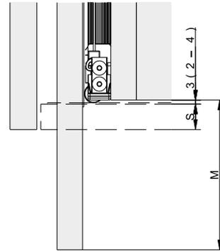
**Ferramenta per ante a scomparsa girevoli in legno fino a 35 kg. Allestimento del frontale uniforme e complanare con schema delle fughe omogeneo. Funzione Push-to-open per costruzioni di armadi senza maniglia.**
