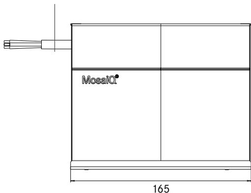
Linea di alimentazione a 3 conduttori, 2 metri
