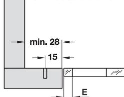
Distanza base di montaggio 9 mm
