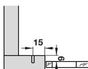
Distanza base di montaggio 0 mm
