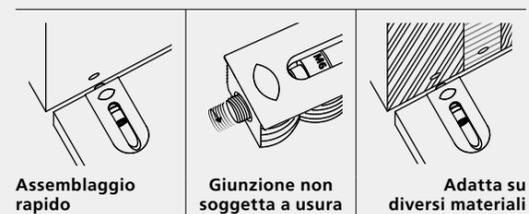
Cabineo 8 M6 è una giunzione monoblocco per armadi che può essere utilizzata con tutte le macchine CNC, poiché viene lavorata solo la superficie del pannello. È ideale per l'assemblaggio di elementi in legno e materiali come alluminio, acciaio o HPL.
