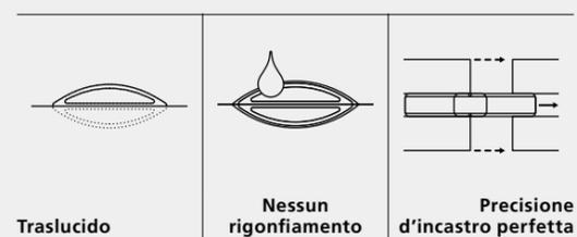
Le lamelle in plastica C10 e C20 sono la soluzione di giunzione collaudata per materiali compositi minerali, come ad esempio Corian o Varicor.
