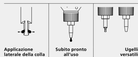
Minicol è uno strumento universale d'incollaggio ed è la soluzione ideale per l'applicazione della colla in fresate da 4 mm.
