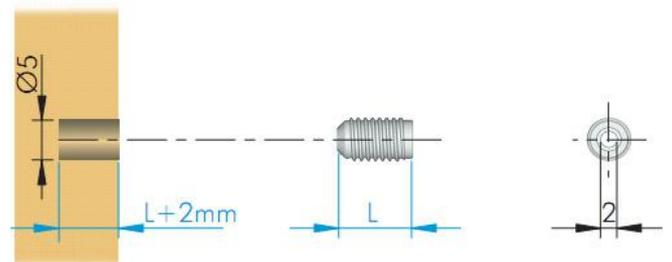
→ **Bussole a nastro con filetto interno M6**
