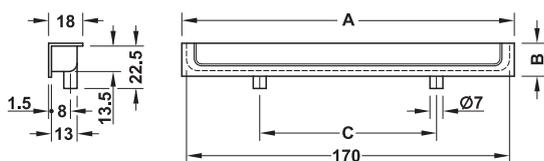
> Montaggio: fissaggio senza viti, da inserire a pressione e incollare
