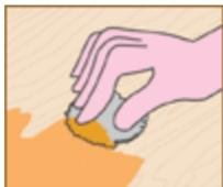
Applicare il prodotto in più strati sottili a pennello o tampone, (evitare bruciature). Dato l'alto residuo secco, su supporti difficili, particolarmente laboriosi, per facilitare la stendibilità, diluire del 10/20% con alcool 99.
